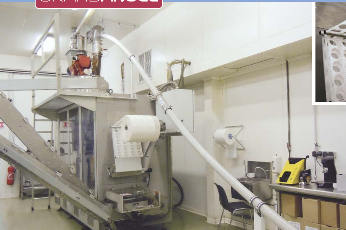
La conditionneuse, du fabricant italien Ica, fonctionne à une cadence de 300 dosettes par minute. Chaque dosette est pesée individuellement. Les dosettes hors poids sont éjectées avant ensachage.
