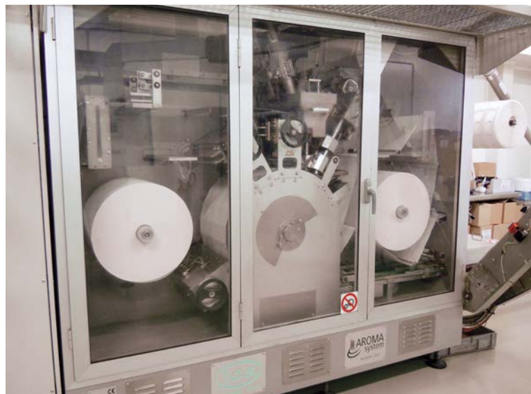
La conditionneuse, du fabricant italien Ica, fonctionne à une cadence de 300 dosettes par minute. Chaque dosette est pesée individuellement. Les dosettes hors poids sont éjectées avant ensachage.
